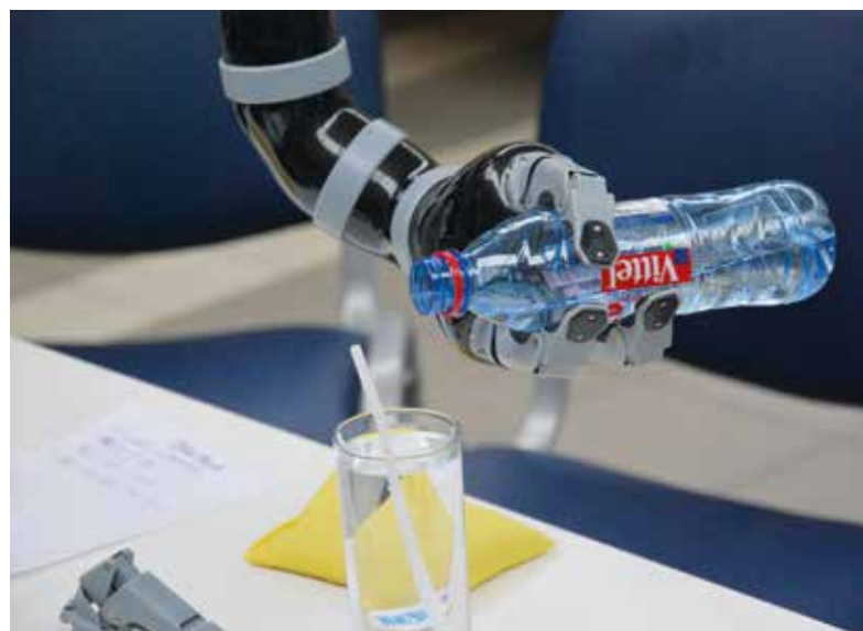
Der Roboterarm „Jaco“ hilft Querschnittgelähmten bei alltäglichen Aufgaben.
